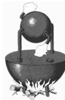
Äolsball: Tangential ausströmender Dampf setzt den Ball in rasche Rotation um die Aufhängung. Vorgänger der Dampfturbine aus dem alten Griechenland
