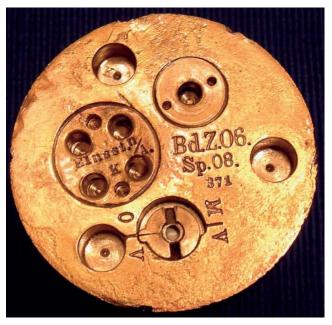
Bei der Einstellung o. V. verfügt der Zünder über eine erhöhte Zündsicherheit, nämlich: beide Zündpillen werden angestochen, versagt, aus welchen Gründen auch immer die Sofortzündung, ist auch die verzögerte Zündung eingeleitet.
