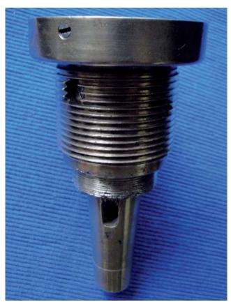
von den in den Granatböden herzustellenden Gewindebohrungen, passend für den BdZ. 06, nicht abgewichen werden sollte. Also erhielten die ansonsten erheblich kleineren BdZ. 10 Adapter aus Eisen mit den Abmessungen des BdZ. 06 (über den langen und kurzen Bodenzünder 10 hatte ich bereits in unseren MITTEILUNGEN-Heft 4 in 2008 berichtet).
