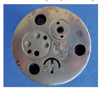
Bodenzünder 10 mit Zündladungsbüchse aus Eisen, wobei der Gewindeteil beim BdZ. 06 etwas länger ist. Hieraus folgt, dass auf Grund der Gewindegleichheit die Zünder Typen BdZ. 06, sowie langer und kurzer Bodenzünder 10, in die gleichen Granatboden Gewindebohrungen passen. Zu vermuten ist, dass seinerzeit
